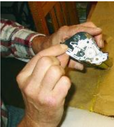
Ennen täyttöä kannattaa nollata kasetin laskurijärjestelmä. 2300W:n kasetissa ei ole laskinpiiriä, sillä päädyssä sijaitseva nylonrattaisto korvaa sen. Tämä on asennettava aloitustilaan jauhekitin mukana tulevan selkeän ohjeen mukaisesti.
