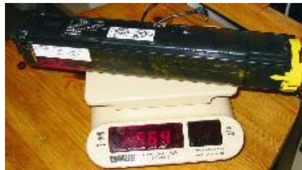
Kasetti poistetaan tulostimesta. Tällä kertaa ensin täytetään keltainen jauhesäiliö.
