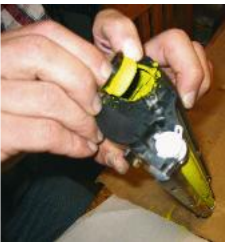
K-M:n kasetit täytetään irrottamalla parin ristipääruuvien lukitsema kansi jauhekasetin laskimen vastapäisestä päädyistä ja avaamalla sen alla oleva säiliön muovinen sulkutulppa.
