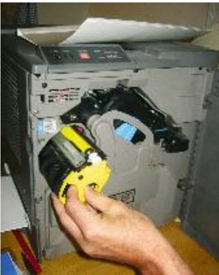
Kasetti poistetaan tulostimesta. Tällä kertaa ensin täytetään keltainen jauhesäiliö.
